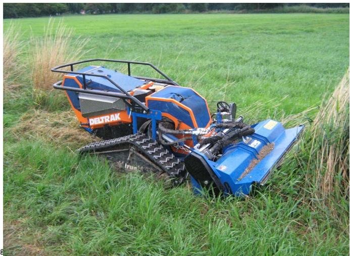
auch Dornen und Gestrüpp ohne Verletzungsrisiko für die Mitarbeiter kurz halten. Durch seine Konstruktion ist er in der Lage, auch in der Böschungsschräge bis zu einer Neigung von 45° zu arbeiten.
